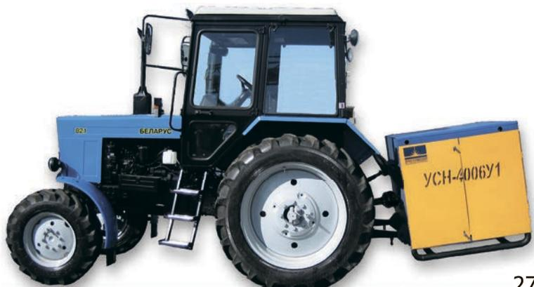
Смонтированы на тракторе Т-10МБ (или Б-10МБ), предназначенном для работы на грунтах с пониженной несущей способностью.
