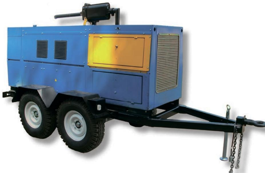
Агрегат предназначен для ведения сварочных работ в условиях строительства и ремонта магистральных трубопроводов. Обеспечивает независимое питание постоянным током одновременно 4-х постов ручной дуговой сварки электродами с любым типом покрытия, а также питание электроинструмента, освещения и прокалочной печи. Приводной двигатель Д-242.
