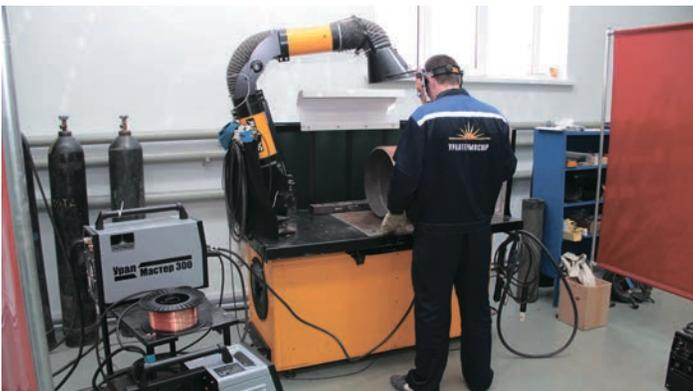
Испытания полуавтоматов на сварочные свойства
