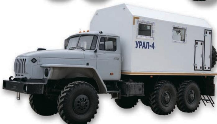
Автомобиль предназначен для проведения сварочных работ в полевых условиях с использованием одновременно до четырех постов электродуговой сварки, питания электроинструмента, других потребителей и освещения рабочих мест в тёмное время суток. Состав устанавливаемого оборудования подбирается индивидуально, под конкретные нужды Заказчика.
