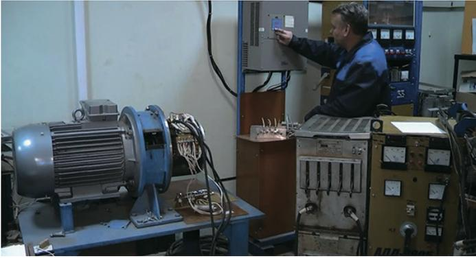
Стенд испытания новых сварочных генераторов
