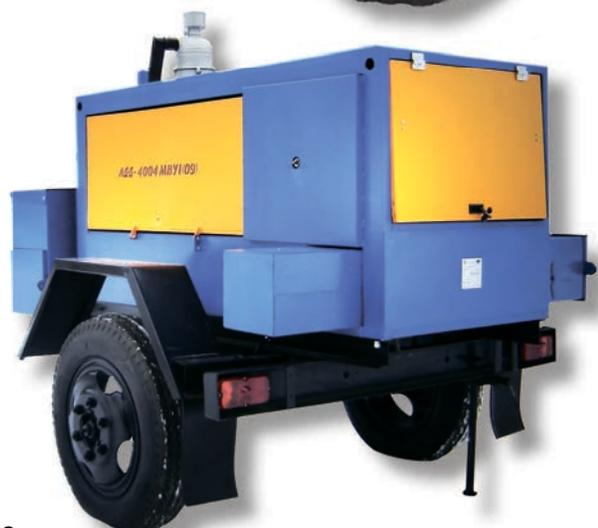
Дизельный двигатель Д-144, контейнеры для одного кислородного и одного пропанового баллонов, барабаны для намотки сварочных кабелей, одноосное шасси.
