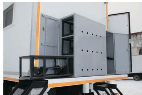
Кузов-фургон из цельных, полноформатных сэндвич-панелей толщиной 50-80мм, собранных по бескаркасной технологии. Наружняя отделка - плакированный металл, утеплитель - стиропен-50. Внутренняя отделка - плакированный металл.
