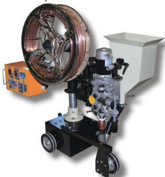
Компактный и облегченный **АДФ-1006 исп.01 Урал** предназначен для сварки под флюсом прямолинейных и криволинейных стыковых швов под флюсом с разделкой и без разделки кромок. Позволяет использовать ролик-копир для движения по стыку. Сцепление и расцепление колес с приводом осуществляется с помощью специальной муфты.
