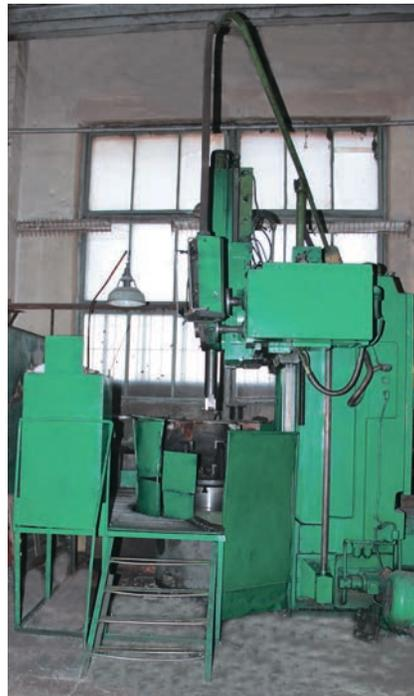
Токарно-карусельный станок для мех. обработки внутренней поверхности станин генераторов серии ГД
