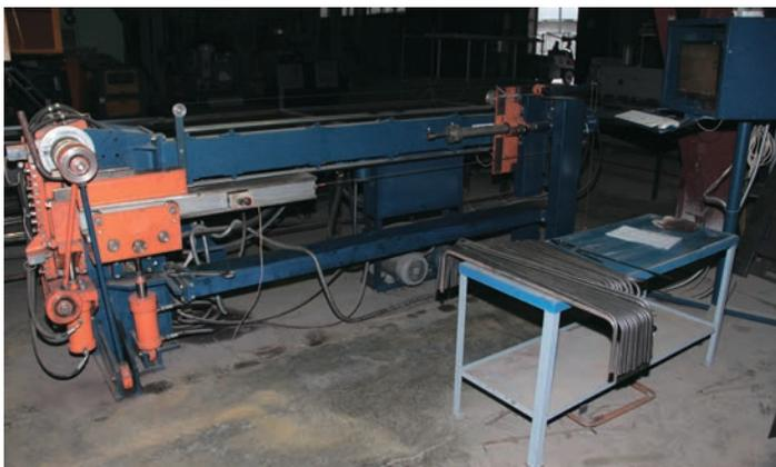
Трубогибочный станок с ЧПУ для изготовления каркасов и рам малогабаритных агрегатов
